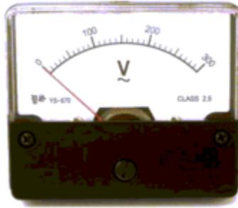
Voltímetro analógico utilizado em painéis elétricos
